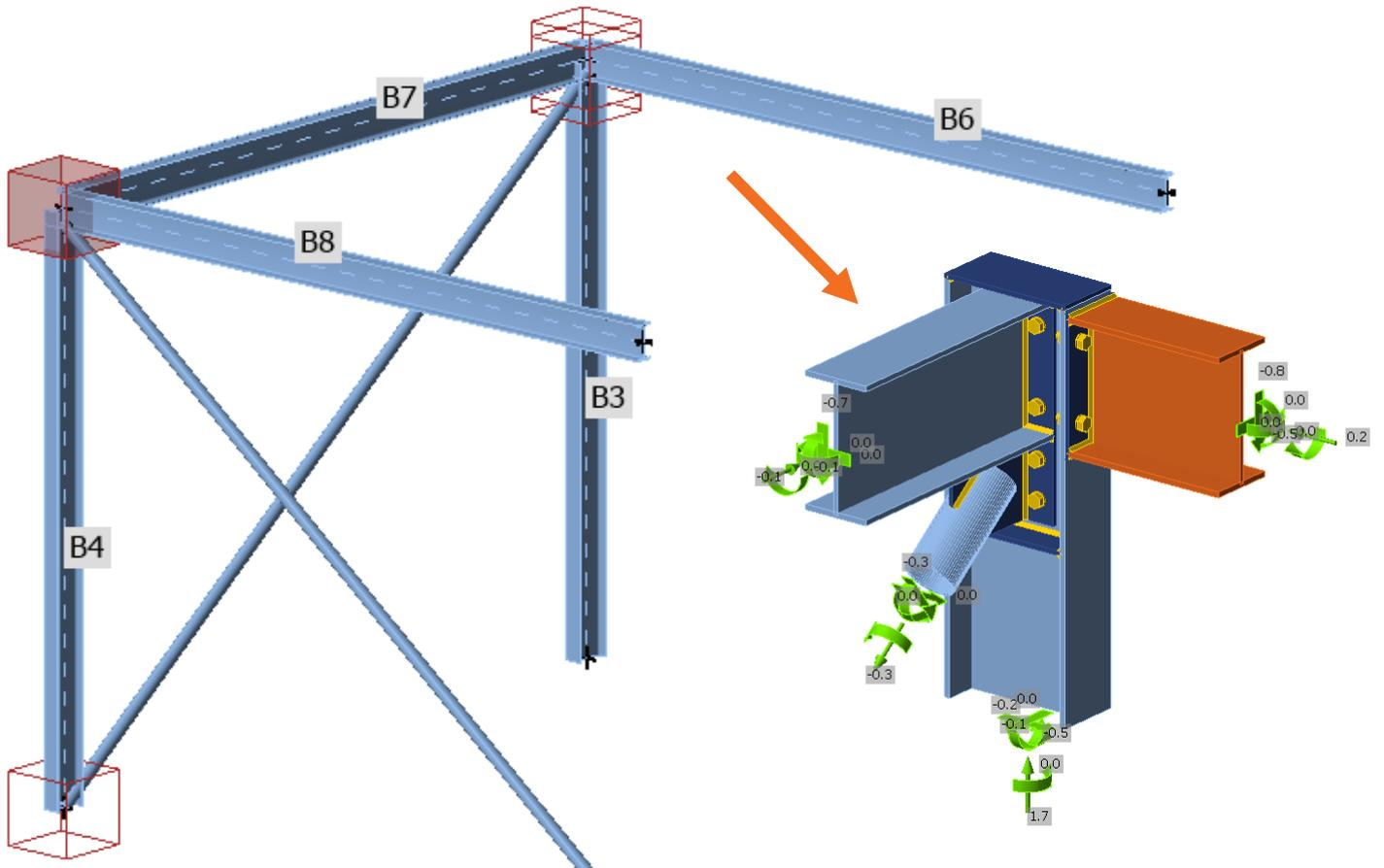
L'opzione migliore è sempre unire nel Checkbot le aste che devono essere continue per esigenze di modellazione della connessione (prima di aprire il nodo in IDEA Connection), utilizzando il pulsante **Unisci**.
