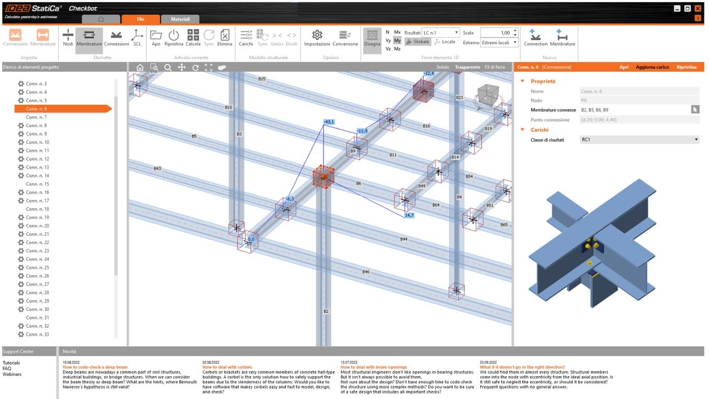
Si può avviare il Checkbot direttamente dal programma CAD/FEA oppure può anche essere avviato come applicazione autonoma, senza un link BIM attivo. In questa modalità, è possibile importare i file IOM o SAF che definiscono un modello strutturale.
