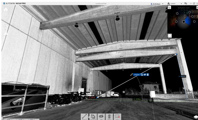
Fig.3.14: Parte esterna rilevata di sera, nell'immagine è possibile notare come vengono prese le misure attraverso il riconoscimento dei piani come il pavimento e come le facce dei pilastri, per esempio
