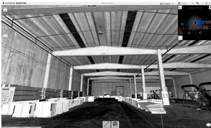
Fig.3.11: Funzione infrarossi del Laser Scanner
