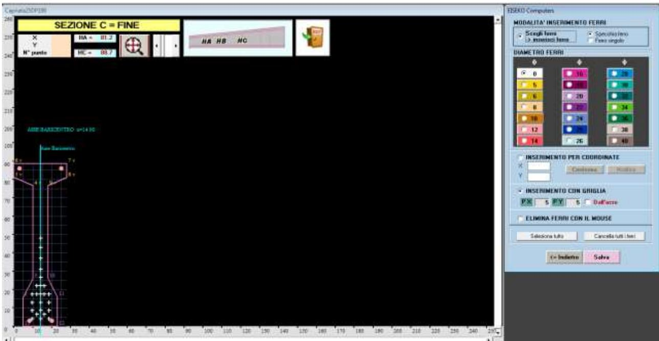
E' possibile inserire i ferri per coordinate o tramite griglia. Si possono inserire i ferri (area>0) o le sole posizioni (area=0). Si consiglia di inserire più posizioni possibili e i ferri più usati con la loro area, così quando si fa un nuovo progetto su questa trave, si avranno i ferri più usati già inseriti e poi sarà possibile aggiungerne o toglierne direttamente dal programma di calcolo.
