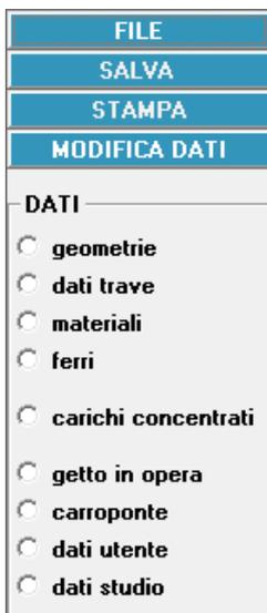
La scheda **“MODIFICA DATI”** permette di modificare tutti i dati introdotti: dati trave, geometria della sezione (se di quelle automatiche), materiali, ferri, getto, carichi concentrati, carroponete, dati dello studio e dati utente (questi ultimi due sono quelli riportati nelle intestazioni delle relazioni e delle tabelle di calcolo).
