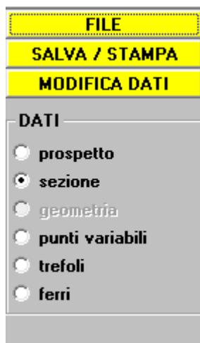
La scheda "MODIFICA DATI" permette di cambiare tutti i dati introdotti: prospetto, sezioni, geometria (attivo solo nel caso di sezione introdotta con il metodo delle sezioni parametriche), punti variabili, trefoli e ferri.
