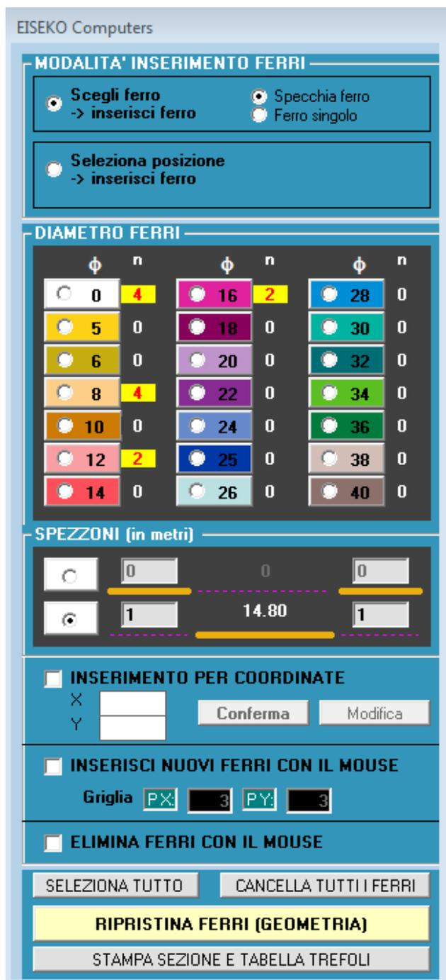
**“SCEGLI FERRO”** Selezionando *“Specchia ferro”*, l’operazione scelta (inserisci, elimina, cambio diametro, spezzone, etc.) verrà eseguita direttamente sui due ferri speculari (se viene trovato il ferro speculare di quello selezionato rispetto al baricentro); invece selezionando *“Ferro singolo”* l’operazione sarà eseguita solo sul ferro selezionato.
