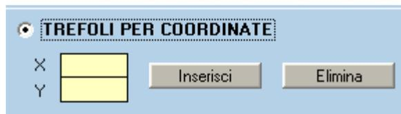
Selezionare l'opzione "Trefoli per coordinate", inserire le coordinate X e Y e premere "Inserisci" per salvare o "Elimina" per eliminare il trefolo.
