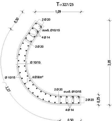
Disposizione delle armature:
