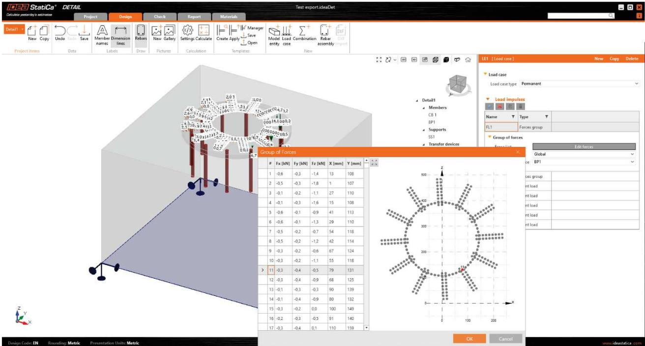
Quando il modello viene importato dall'applicazione Connection, gli impulsi di carico vengono creati automaticamente.
