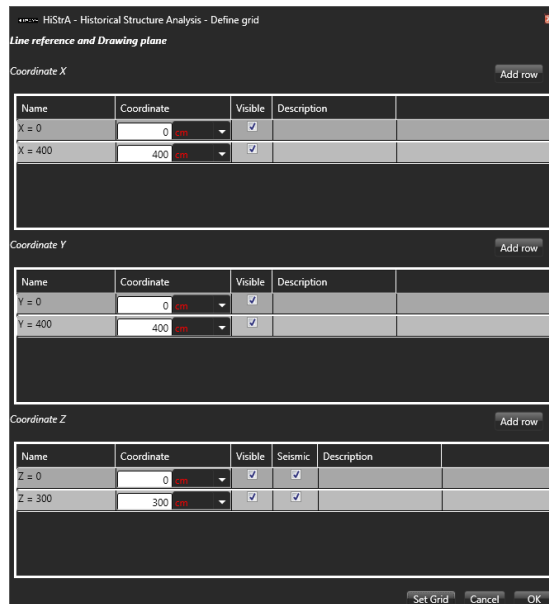
Figura 22 – Finestra Line reference and Drawing plane per l'impostazione delle linee griglia di riferimento
