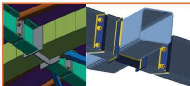
Studio delle connessioni di un tunnel di collegamento di 130 m lunghezza, soprastante una strada carrabile.
