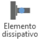
Si prevede che la cerniera plastica si formi in corrispondenza di un *elemento dissipativo* e che tutti gli elementi non dissipativi del giunto siano essere in grado di trasferire in modo sicuro le forze durante lo snervamento nell'elemento dissipativo. È possibile definire l'elemento dissipativo in elementi o piastre selezionati, applicando il *fattore di sovrarresistenza*  $\gamma_{ov}$ . Inoltre, può essere personalizzato anche il *fattore di incrudimento*  $\gamma_{sh}$ .
