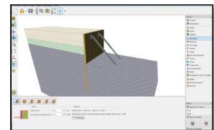
Analisi più avanzate di strutture ancorate (compreso lo spostamento della struttura) possono essere eseguite utilizzando il programma GEO5 "Verifica Paratie", con il metodo elasto-plastico non lineare. Il programma "Stabilità dei Pendii", invece, consente la verifica globale della struttura.
