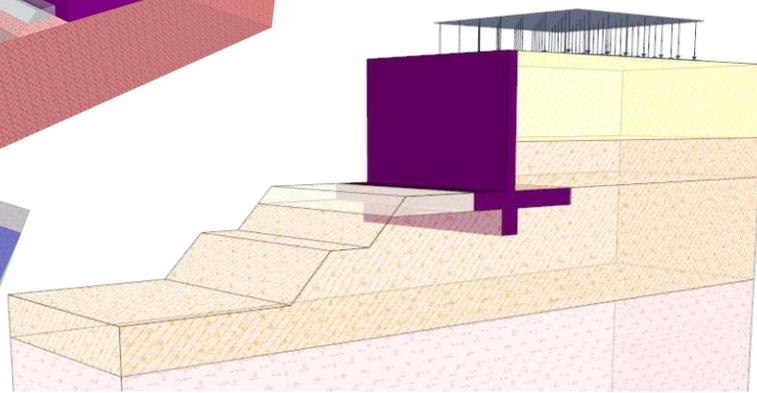
GEO5 ha a disposizione una vasta gamma di programmi per la progettazione e l'analisi di muri di sostegno e strutture di contenimento. Questi programmi forniscono la verifica del ribaltamento, verifica a traslazione sul piano di posa e verifica della capacità portante del terreno di fondazione. Consentono all'utente di verificare la resistenza della sezione trasversale (calcestruzzo, cemento armato, muratura) o la stabilità dei blocchi che costituiscono il muro.
