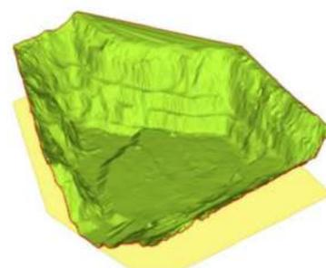
RIDUZIONE AUTOMATIZZATA DEL NUMERO DI PUNTI E INSERIMENTO DEL RILIEVO NEL SOFTWARE STRATIGRAFIA
