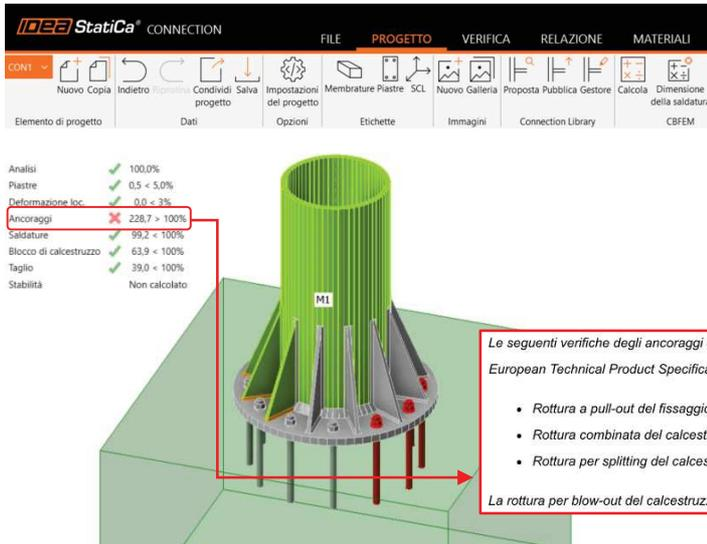
Nel caso in cui la verifica degli ancoraggi non sia soddisfatta in IDEA Connection e venga segnalato che è necessario eseguire determinate verifiche utilizzando altri metodi, oppure altri software specifici forniti dai produttori di fissaggi; ora è possibile risolvere direttamente utilizzando il software **IDEA Detail 3D** grazie al **collegamento diretto tra l'applicazione Connection e Detail**.
