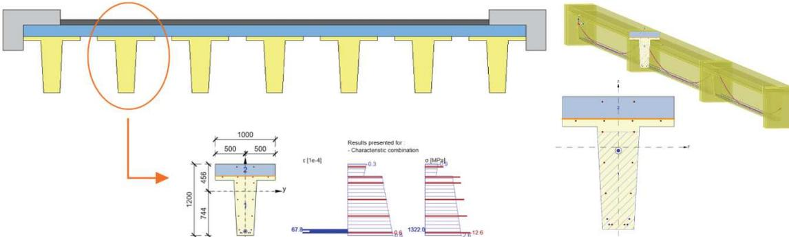
**Spostamenti non lineari, deformazioni a lungo termine, verifica di stabilità laterale;**
