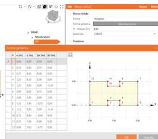
**Volumi Negativi:** con l'operazione *Taglio*, è possibile modellare il blocco per sottrazione di volumi
