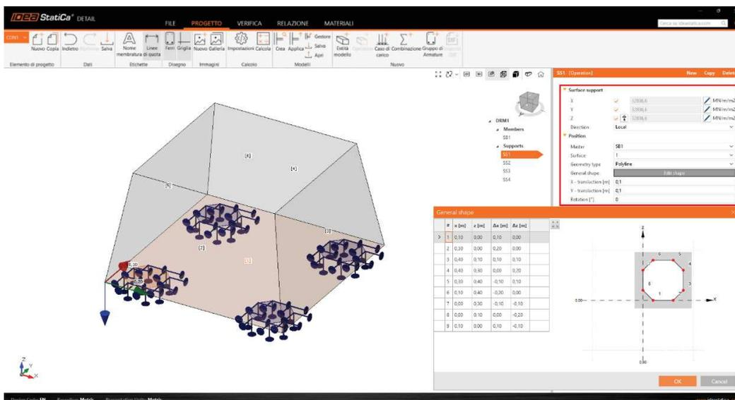
Il vantaggio del supporto di superficie è la possibilità di **definire la rigidità e impostare un comportamento non lineare** che simula il contatto con il terreno. I supporti definiti da una forma generale (polilinea) possono essere utilizzati per simulare i **pali**.
