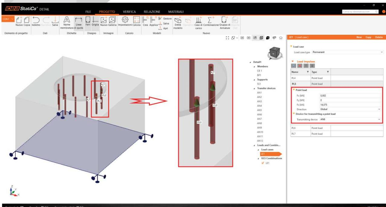
Per ogni effetto di carico calcolato in Connection, il caso di carico corrispondente e la combinazione SLU vengono creati automaticamente in Detail.
