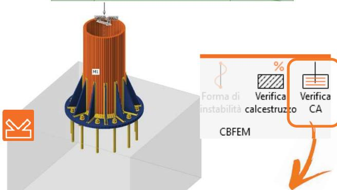
L'esportazione da Connection in IDEA Detail è consentita per **nodi di base con ancoraggi** e permette il trasferimento:
