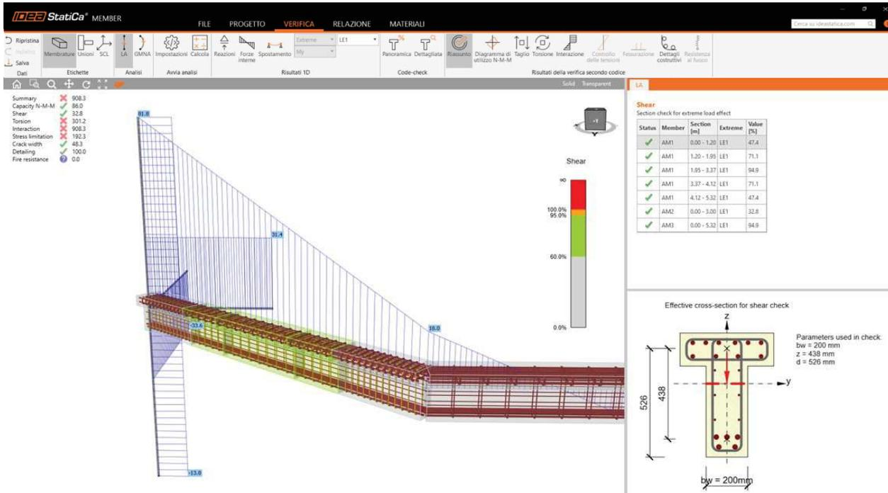
In IDEA Member l'analisi è eseguita in **tre fasi** che utilizzano la tecnologia CBFEM. Prima si lancia l'analisi **MNA (Analisi Non lineare per il Materiale)** per verificare la capacità strutturale; quindi, si calcola il **LBA (Analisi di Buckling Lineare)** per indagare la stabilità strutturale e infine si tiene conto anche delle imperfezioni iniziali per le opportune forme di instabilità calcolando la **GMNA (Analisi non lineare per geometria e materiale con imperfezioni)**.
