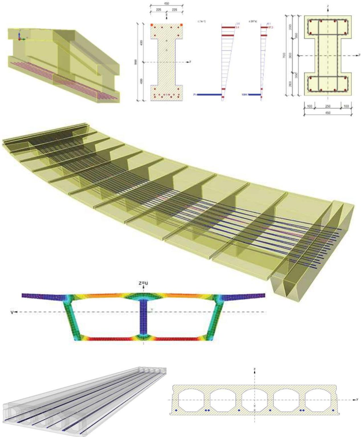
**Sezioni composte con qualsiasi tipologia di trefolo, perdita di precompressione, effetti della precompressione;**
