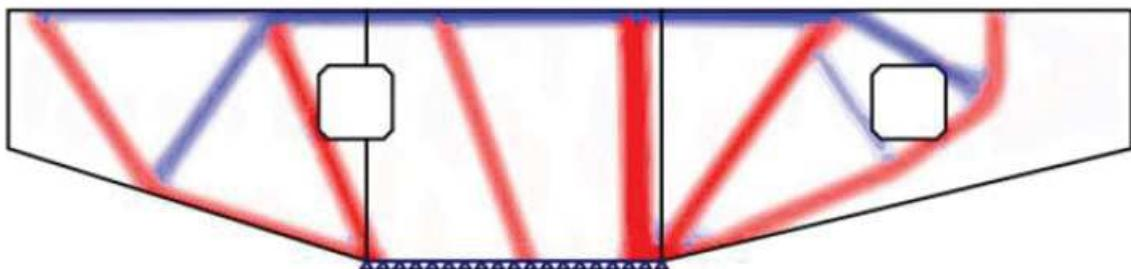
Risultati dello strumento di progettazione per l'ottimizzazione della topologia con volume effettivo del 20%
