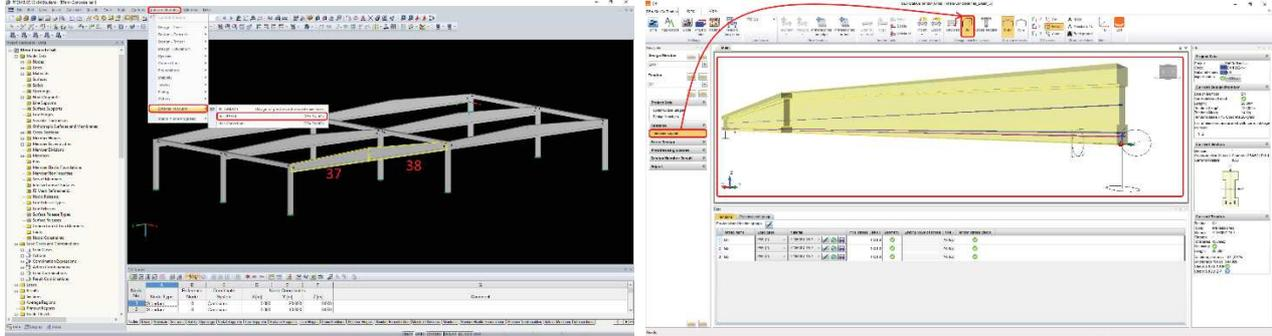
Modello di RFEM: trave importata automaticamente in IDEA Beam
