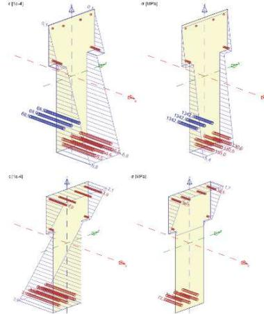
Interazione sulla sezione precompressa
