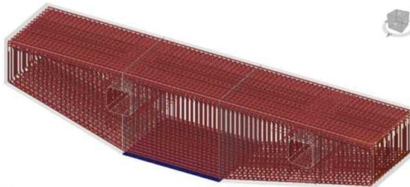
Modello delle armature IDEA Detail
