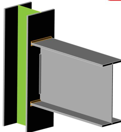
Saldatura parziale: è possibile determinare la lunghezza del tratto saldato
