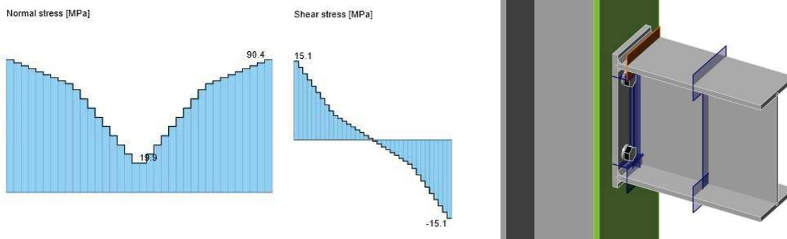
Il tipo di analisi a fatica non fornisce alcuna resistenza finale o numero di cicli che il dettaglio può sostenere. Fornisce solo l'input per ulteriori calcoli in accordo ai codici (tensioni nominali e sezioni definite automaticamente). La tensione nominale può essere calcolata per:
