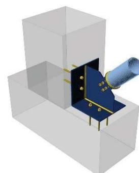
Le operazioni di produzione *Piastra di base* o *Griglia di ancoraggi* possono essere utilizzate anche in casi diversi dal collegamento a terra come parapetti, mensole, tiranti ecc.
