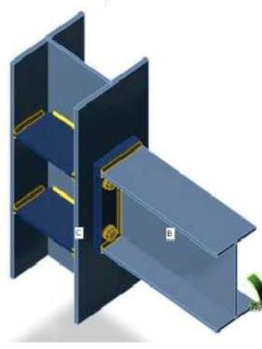
Nodo rigido: connessione saldata
