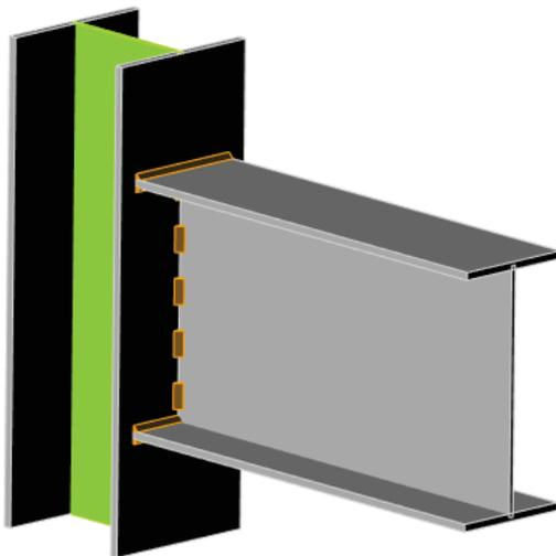
Saldatura intermittente: è possibile determinare la lunghezza e la spaziatura del tratto saldato
