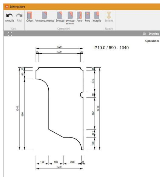
Connessione con piastre di forma generica create importando i disegni .dxf
