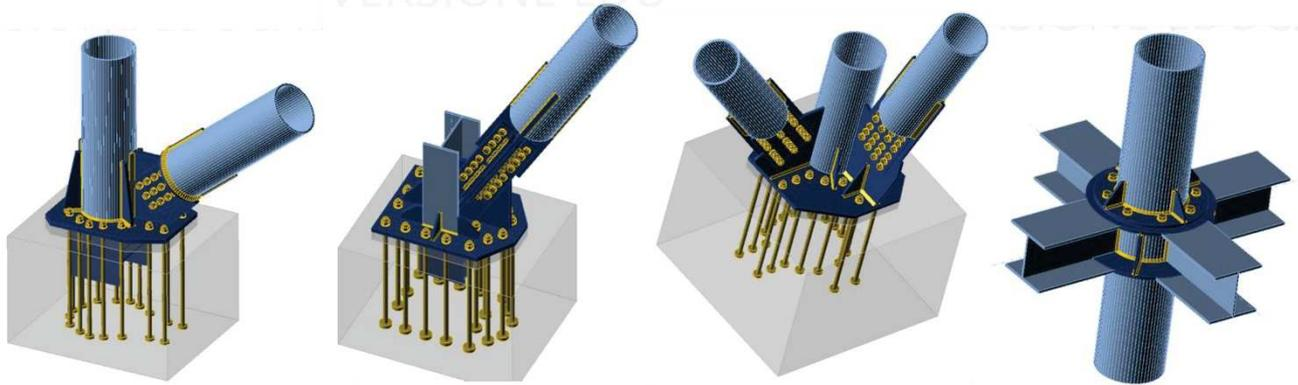
Verifica delle connessioni non standard dell'Edificio di ricezione e pre-trattamento dell'Impianto trattamento rifiuti a Pontedera (PI) – Ing. Bruno Boldrin
