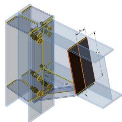
La verifica di sforzo/deformazione è pienamente soddisfatta per la connessione
