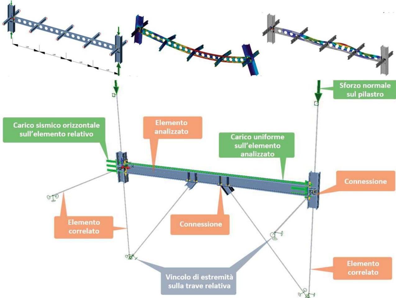
In IDEA Member l'analisi è eseguita in **tre fasi** che utilizzano la tecnologia CBFEM. Prima si lancia l'analisi **MNA (Analisi Non lineare per il Materiale)** per verificare la capacità strutturale; quindi, si calcola il **LBA (Analisi di Buckling Lineare)** per indagare la stabilità strutturale e infine si tiene conto anche delle imperfezioni iniziali per le opportune forme di instabilità calcolando la **GMNIA (Analisi non lineare per geometria e materiale con imperfezioni)**.
