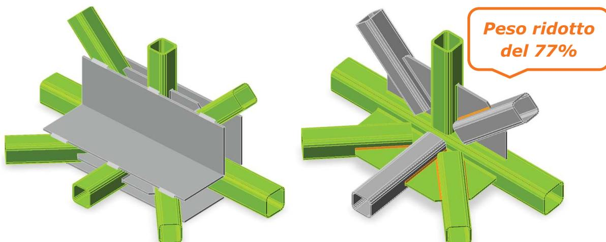
**Risparmio del 77% di materiale** ottenuto in fase di progetto preliminare della connessione in un progetto reale (estensione dell'aeroporto di Heathrow). Le parti sottoutilizzate possono essere rapidamente identificate dal colore grigio.
