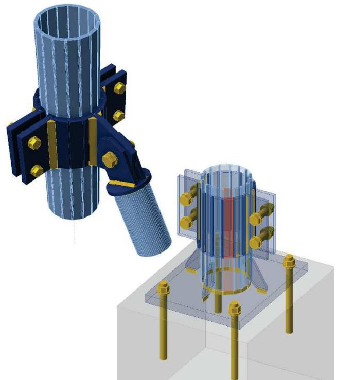
Connessione a collare che necessita del contatto tra le superfici degli elementi tubolari.
