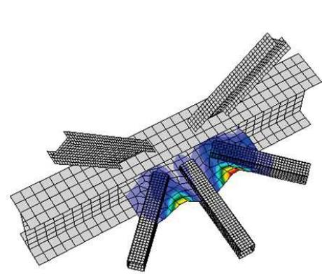
Rappresentazione della curva di stabilità in base al fattore di carico critico e relativa deformata.
