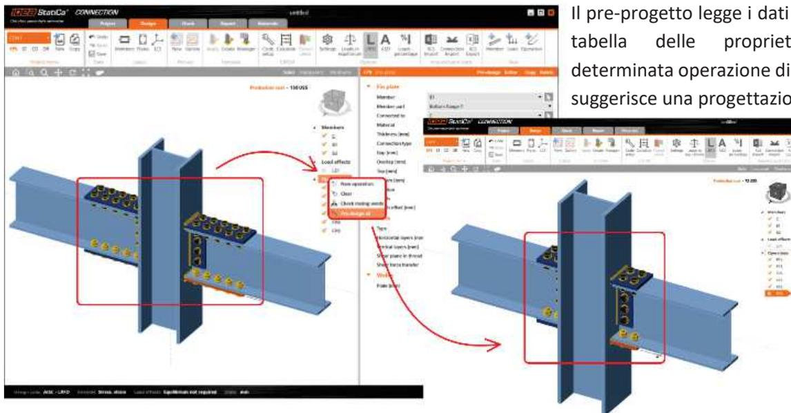
Il pre-progetto legge i dati di input dalla tabella delle proprietà di una determinata operazione di produzione e suggerisce una progettazione iniziale.
